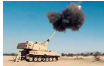
Früher Prototyp von ERCA auf Chassis der M109A6 (sieben Laufrollen).
