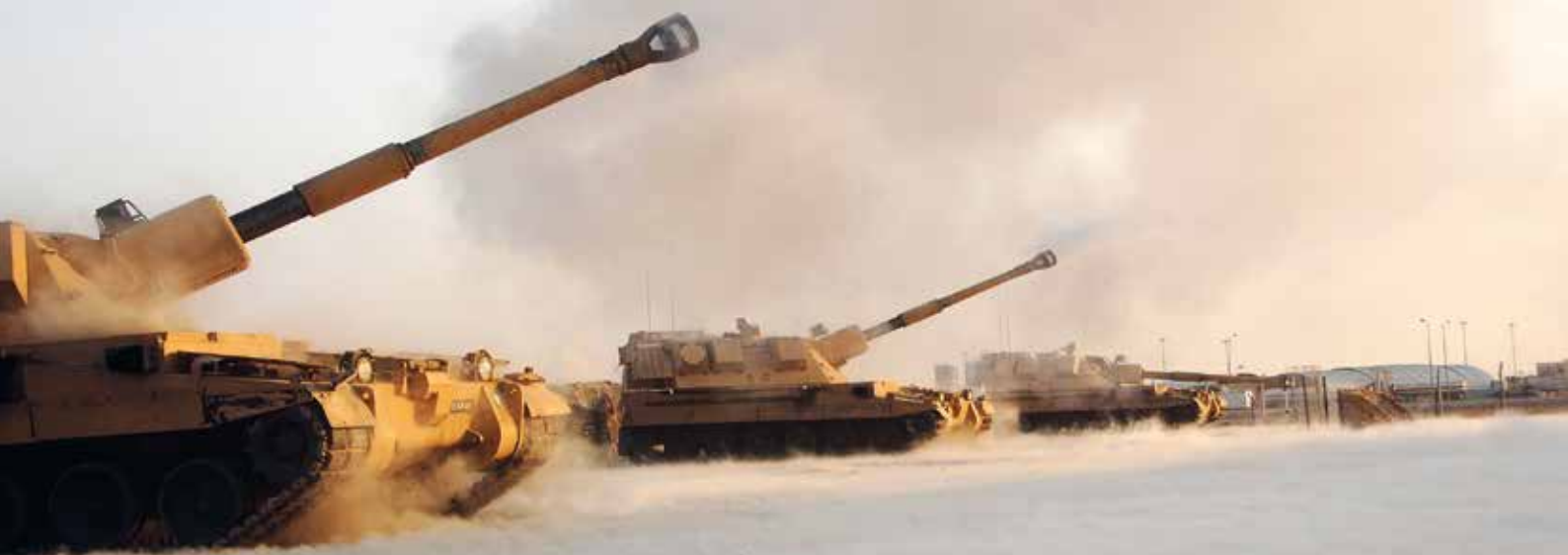
AS-90 («Artillery System for the 1990s»); bereits in den 1990er-Jahren konnte dieses Geschütz innert weniger als zehn Sekunden drei Schuss verschossen. Foto: Wikipedia, 2021.
