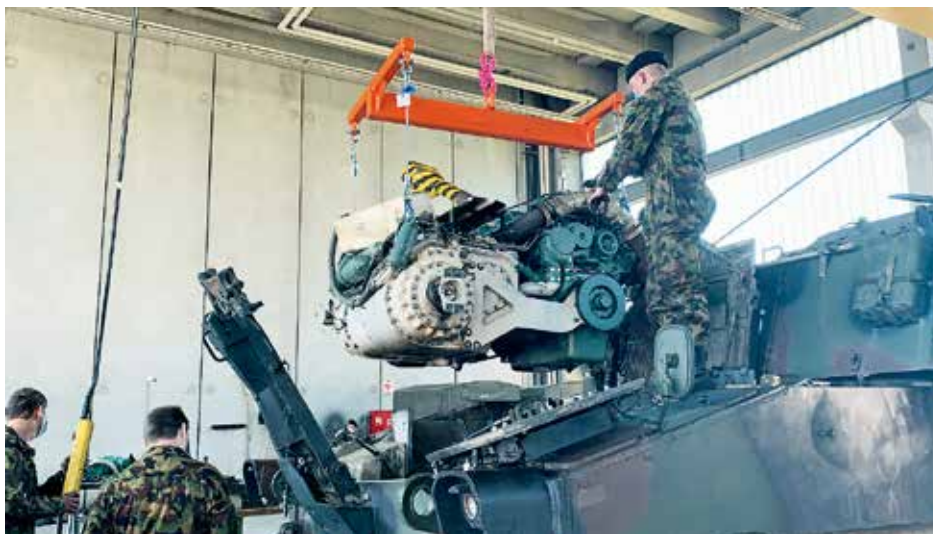
Truppenhandwerker beim Ausbau einer Antriebsgruppe bei einer Pz Hb M109. Die Abt Werkstatt leistete Toparbeit. 1243 Arbeitsstunden, die Hälfte davon für Rpe Fz, waren dieses Jahr für die Instandstellung nach der Fassung nötig.
