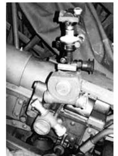
Richtaufsatz der 7,5-cm-Feldkanone 03 mit dem Trommelaufsatz Modell 1931.<sup>16</sup>
