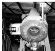
Rohr der 8pfdr Kanone Ordonnanz 1869 mit Verschluss, Visier seitlich nach rechts verlegt<sup>12</sup>. Der Pfeil zeigt die seitlich verlegte Visierlinie an.
