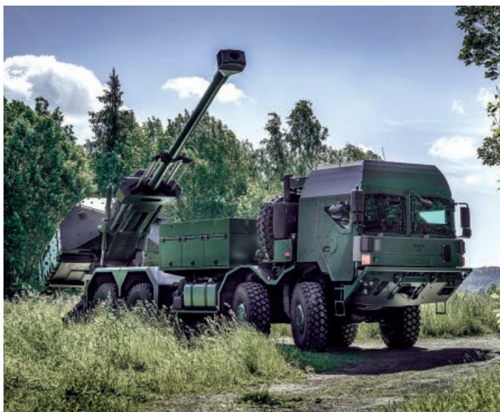
◀ Archer von BAE Systems aus Schweden auf einem Rheinmetall 8x8-Lastwagen. Bild: BAE Systems
