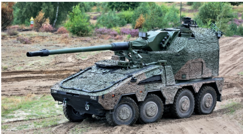
▼ RCH 155 von Krauss-Maffei Wegmann aus Deutschland mit einem Boxer-Fahrgestell. Bild: KMW
